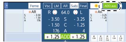
Durch erneutes Drücken von **ADD** wird die Anzeige ADD auf ihren Ausgangszustand zurückgesetzt, und die Addition wird platziert. Durch Drücken von **LM**, **AR**, **Subj** oder **Final** kann der Modus bei eingestelltem ADD-Modus geändert werden.
