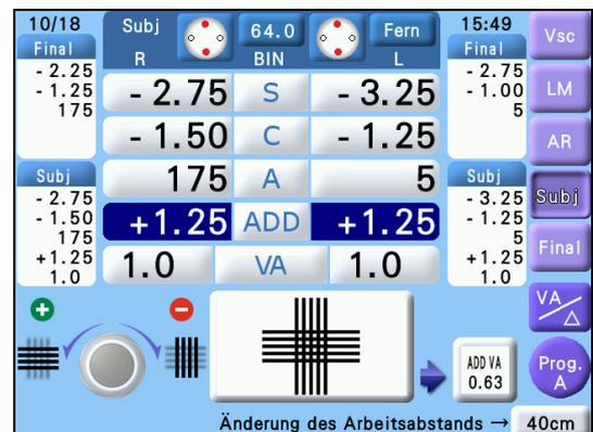
Horizontale Reihen → Drehen Sie den Drehknopf in Einzelschritten entgegen dem Uhrzeigersinn, bis die Reihen gleich scharf erscheinen.
