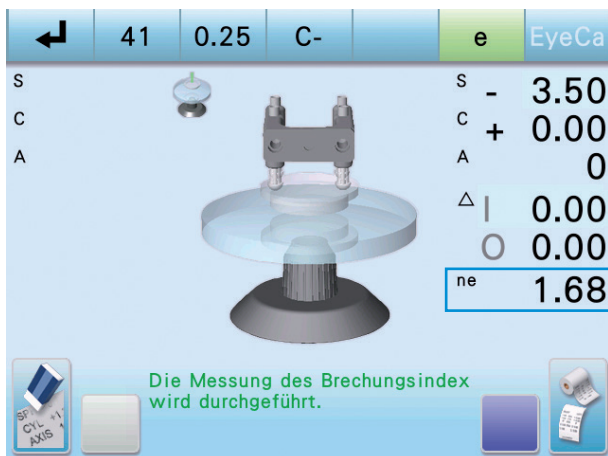
Messung der Brechzahl eines Glases mit den optionalen Gel-Pads
