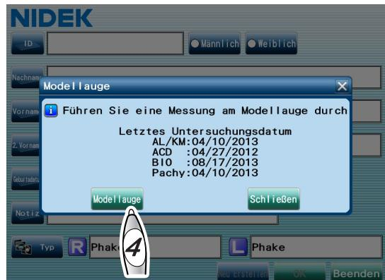
**4** Drücken Sie die Taste Modellauge, und führen Sie dann eine Modellaugenmessung und Überprüfung vor dem Gebrauch durch.
