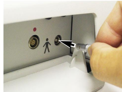
**⚠️ VORSICHT** • Unterlassen Sie das Anschließen oder Abtrennen der Kabelstecker der A-Scan- und Pachymetriesonde während der Messung.
