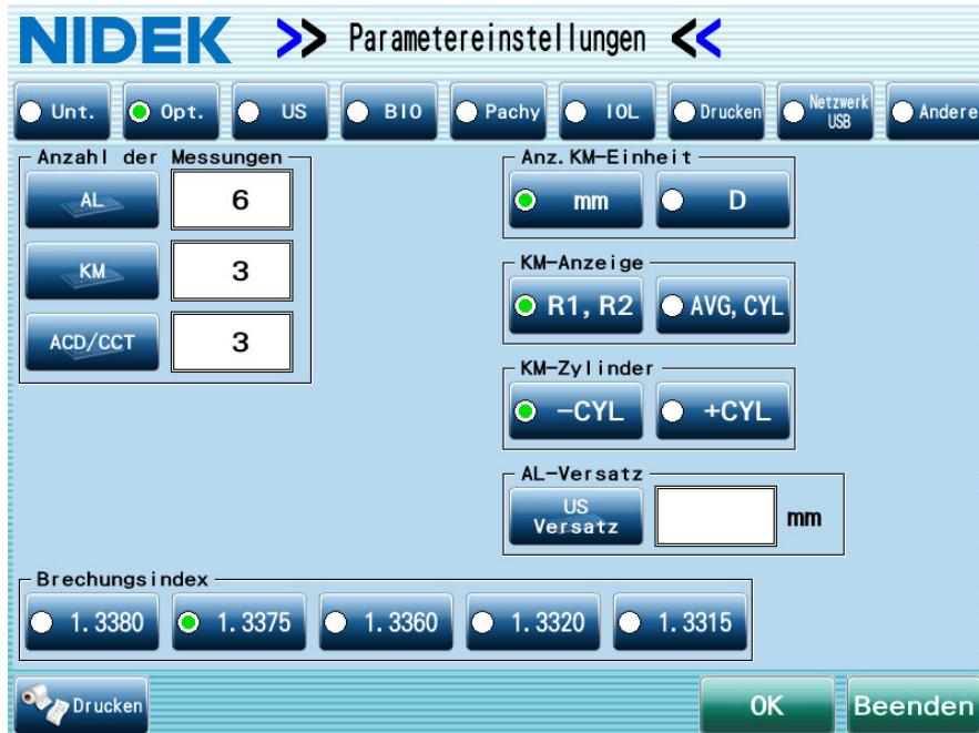
**Anzahl der Messungen:** Einstellungen für die Anzahl der Messungen für Axiallänge (AL), Hornhaut-Krümmungsradius (KM) und Vorderkammertiefe / zentrale Hornhautdicke (ACD/CCT)
